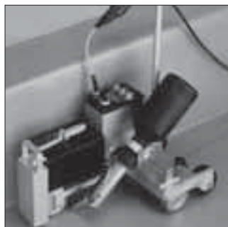
Saldatura ad aria calda
